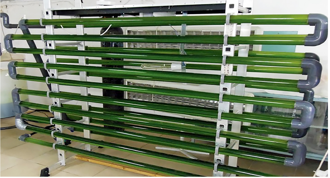
ŞEKİL 10. Tübüler fotobiyoreaktörde Chlorella vulgaris üretimi (Özdemir vd., 2015)
