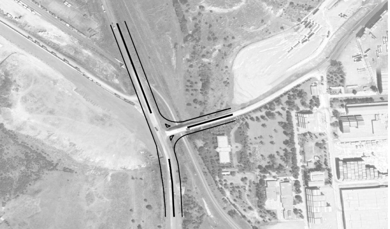
ŞEKİL 3.9. Seviyeli Kavşak Bağlantısı ile Batı Limanları Arasında Yolun Limanlar Yoluna Bağlandığı Noktadaki Kavşak Düzenlemesi
