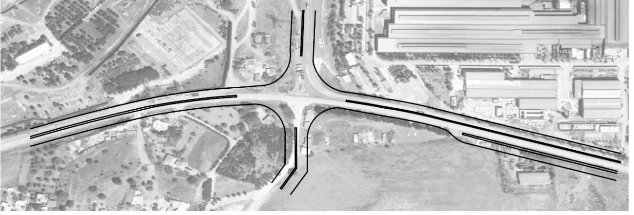
ŞEKİL 3.5. Yeni Foça Otoyol Bağlantısına Bağlanacak Yolların Sanayi Caddesi'ne Bağlandığı Noktadaki Kavşak Düzenlemesi: Batı Kavşak
