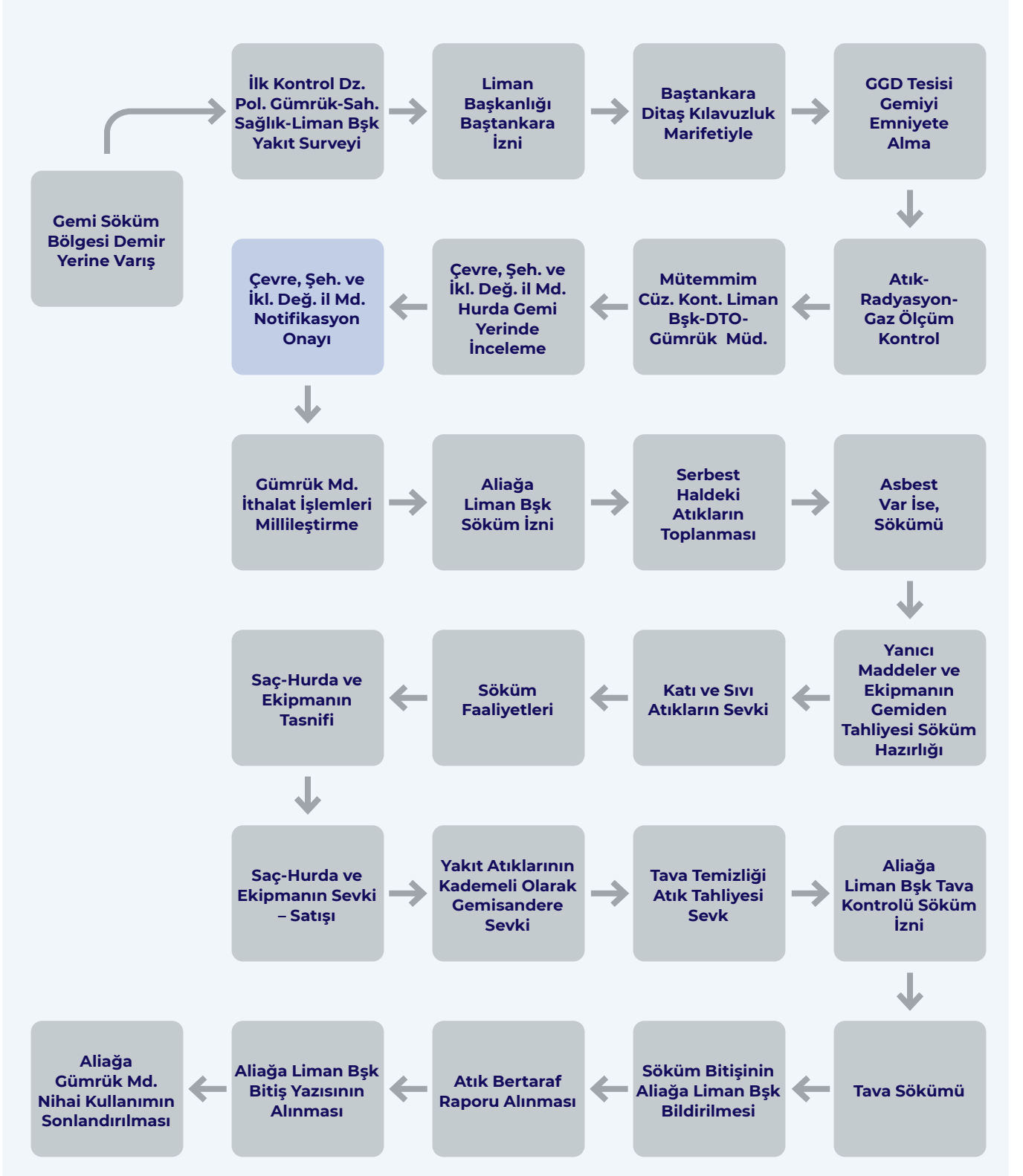
ŞEKİL 29. Aliğa Gemi Geri Dönüşüm Tesislerinde Gemi Geri Dönüşüm Sıralı İşlemleri (Ön bildirim Ticari Gemiler) (GEMİSANDER, 2021).
