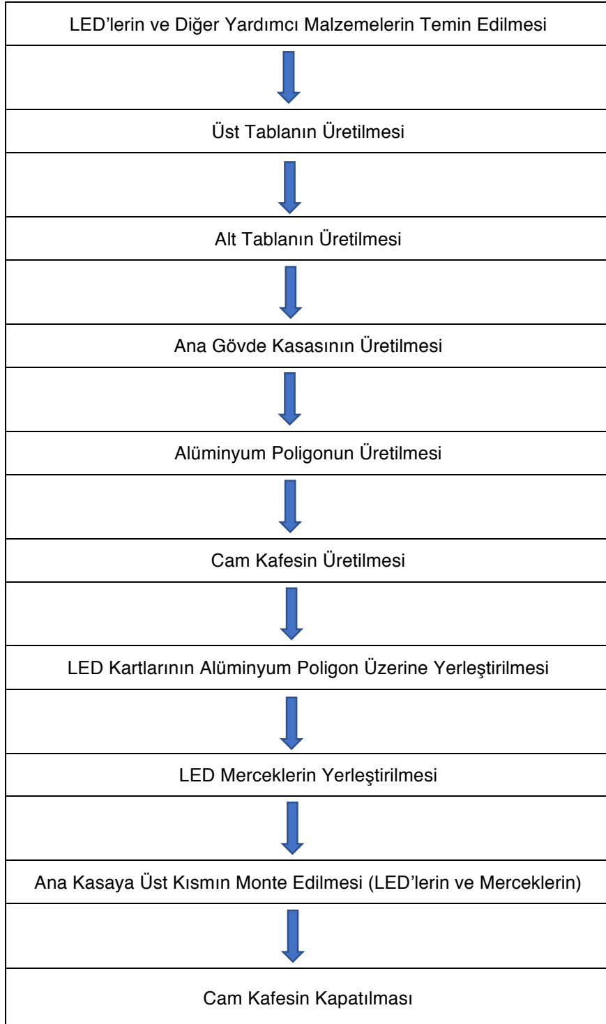
Şekil 12. Orta Yoğunluklu Havacılık İkaz Lambası Üretim Akışı Şeması
